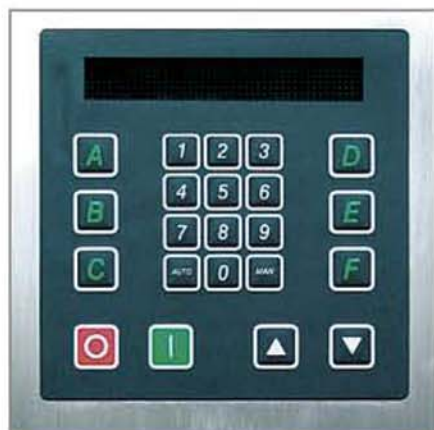
Controllo Standard (S): durante il ciclo, il display informa l'operatore sulla temperatura, sul tempo residuo e sul tempo del ciclo di raffreddamento.
