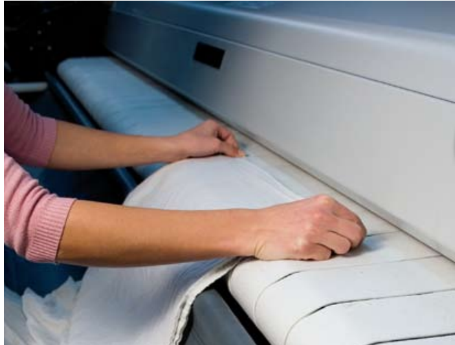
La protezione delle mani con doppio sensore controlla la posizione attiva e di riposo.
