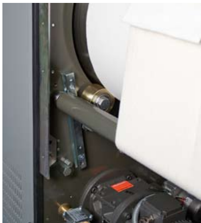
Il sistema cinematico di tensione delle bande (Pat 0528745) assicura un'impeccabile qualità di stiratura
